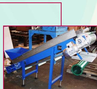
Pokud je vrstva materiálu vysoká, lze separaci rozšířit o magnetický buben na konci dopravníku.
