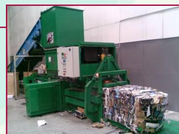
Chod trhače je hlídán reverzační automatikou, která v případě přetížení vypne zařízení, provede zpětný chod a poté opět zapne do režimu drcení. Automatika zajišťuje také postupný rozběh trhače a případné spuštění vstupních a výstupních dopravníků.
